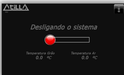
Para desligar seu torrador, vá até o painel, clique em "Menu" e em seguida "Desligar", confirme clicando em "sim". A máquina se desligará sozinha quando atingir a temperatura ideal.
